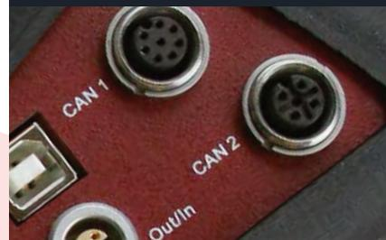
CANbusセンサーや計算、システムJ1939測定を強化するために、2つの独立したポートCANラインをビルトイン。
