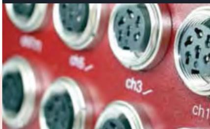
8つの高速(最大0.1ms)測定チャンネル。選択可能な2つのアナログまたは周波数チャンネルにより、柔軟性が向上します。
